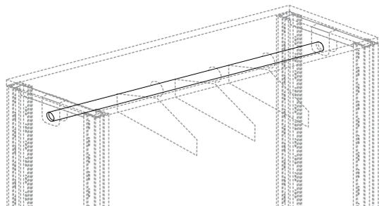
**PORTAGRUCCE** in tubo  $\varnothing$  mm. 21, **solo zincato**. Ogni campata deve avere minimo 1 piano a terra, 1 centrale e 1 di sommità per la stabilità della struttura. I traversini di sommità sostengono sia i supporti del tubo portagruccie che il piano, utilizzando gli stessi ganci. Nel caso in cui si voglia posizionare un portagruccie centrale occorre acquistare 2 traversini supplementari e 1 piano con ganci.
