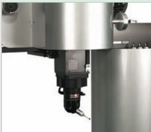
Tastatore Renishaw MH201 orientabile e indexabile (opzionale). MH201 Renishaw sensor indexable (optional).
