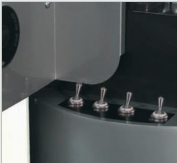
Gli assi X, Y e Z possono essere disinseriti. X, Y and Z axes can be disconnected.
