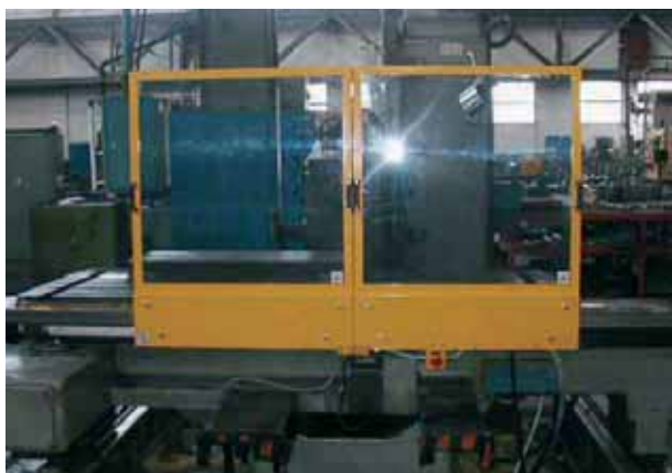
▶ Protezione per rettifica (SR Doppio) ▶ Protection for grinding machine (Double SR) ▶ Protection pour rectifieuses ▶ Protección para rectificadora (doble SR)
