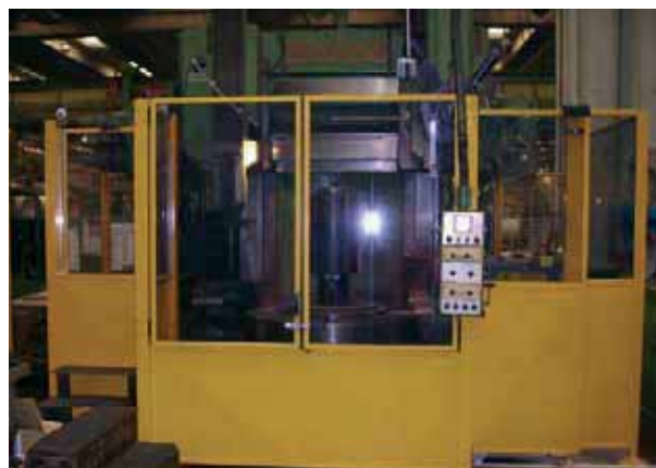
▶ Protezione per tornio verticale ▶ Protection for vertical lathe ▶ Protection pour tours vertical ▶ Protección para torno vertical
